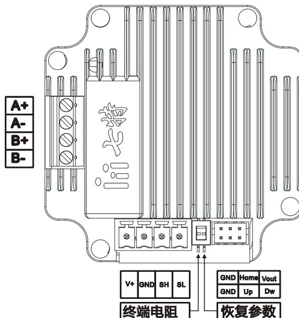
图 1: 步进一体机电气接口图
